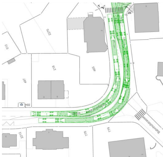
Abbildung 4: Schleppkurven LKW, Gösgerstrasse
