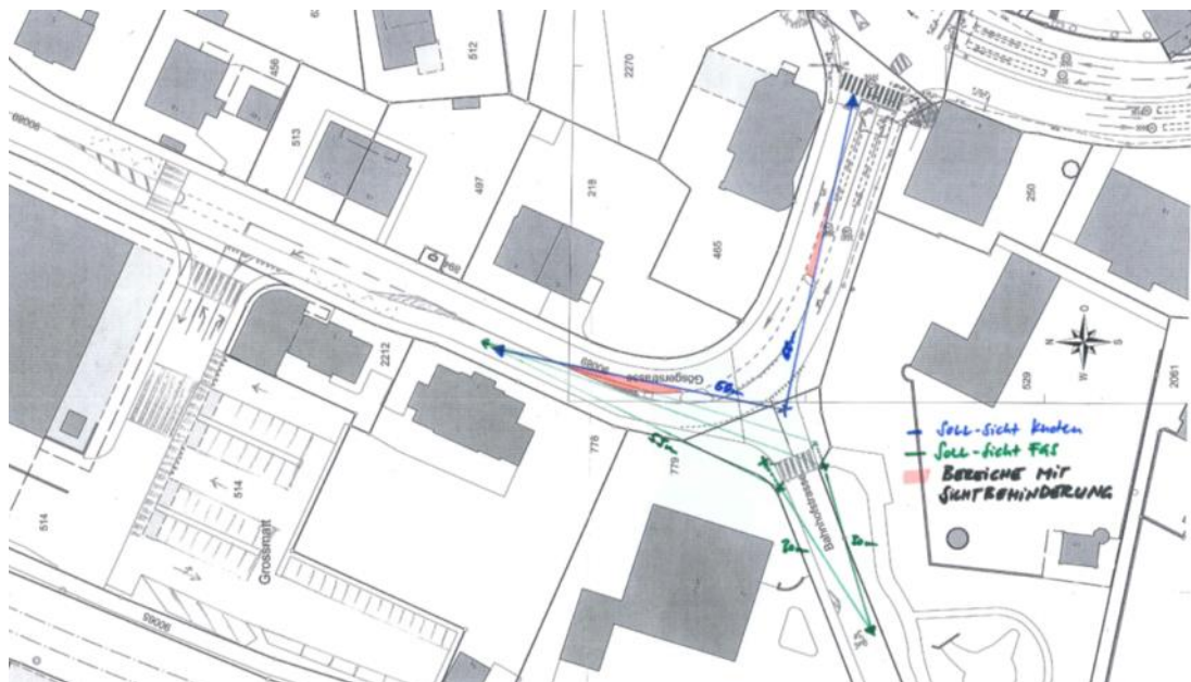
Abbildung 1: Skizze Knoten- und Fussgängersichtweiten
